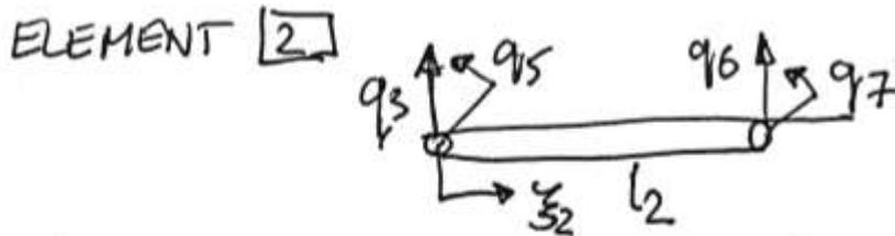
$$[K]_2 = \frac{2EJy_2}{l_2^3} \begin{bmatrix} 6 & 3l_2 & -6 & 3l_2 \\ 3l_2 & 2l_2^2 & -3l_2 & l_2^2 \\ -6 & -3l_2 & 6 & -3l_2 \\ 3l_2 & l_2^2 & -3l_2 & 2l_2^2 \end{bmatrix} ;$$
