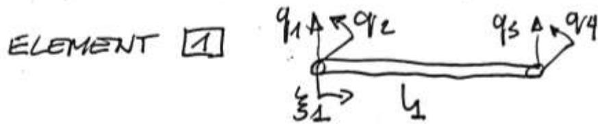
$$[K]_1 = \frac{2EJy_1}{l_1^3} \begin{bmatrix} 6 & 3l_1 & -6 & 3l_1 \\ 3l_1 & 2l_1^2 & -3l_1 & l_1^2 \\ -6 & -3l_1 & 6 & -3l_1 \\ 3l_1 & l_1^2 & -3l_1 & 2l_1^2 \end{bmatrix} ;$$
