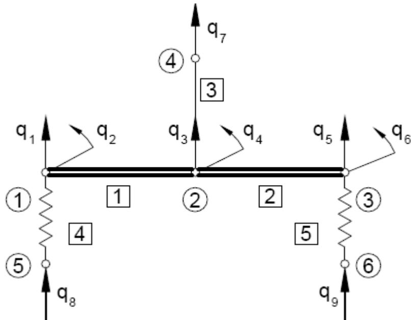
$$\{q\}_g = \begin{Bmatrix} q_1 \\ q_2 \\ q_3 \\ q_4 \\ q_4 \\ q_4 \\ q_7 \\ q_8 \\ q_9 \end{Bmatrix}$$
