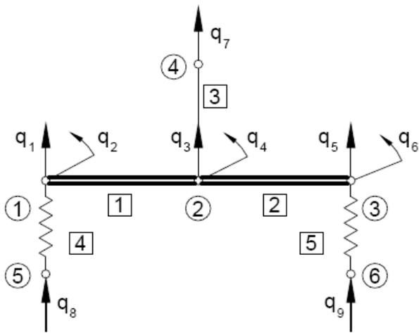
$$[k]_e^1 = [k]_e^2 = \frac{2EI}{l_1^3} \begin{bmatrix} 6 & 3l_1 & -6 & 3l_1 \\ 3l_1 & 2l_1^2 & -3l_1 & l_1^2 \\ -6 & -3l_1 & 6 & -3l_1^2 \\ 3l_1 & l_1^2 & -3l_1 & 2l_1^2 \end{bmatrix}$$
